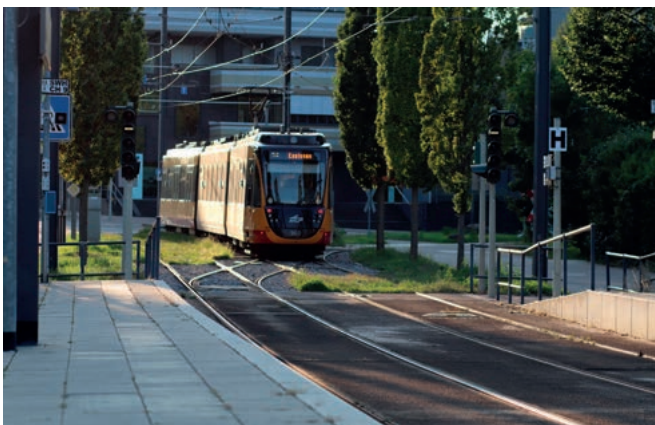
Nära räl får träden inte störa det fria rummet, bild: Open source
